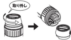
印面台を動きが止まる位置まで反時計回りに廻すと印面台の固定が解除され、取り外せる状態になります。
