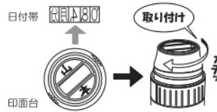
印面台を左図のように日付帯に対して傾けた状態で設置。
